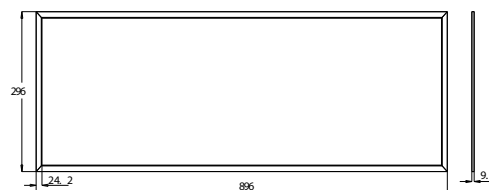
AL-PL/1XX30X90/C Panel Luminoso 30x90cm SMD3528 VOLTAJE / AC 100 - 240 V CONSUMO / 40 W LÚMENES (lm) / BL 2900
